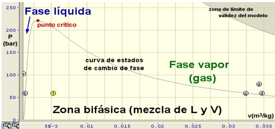
Fig. E3.1b.- Diagrama Pv
